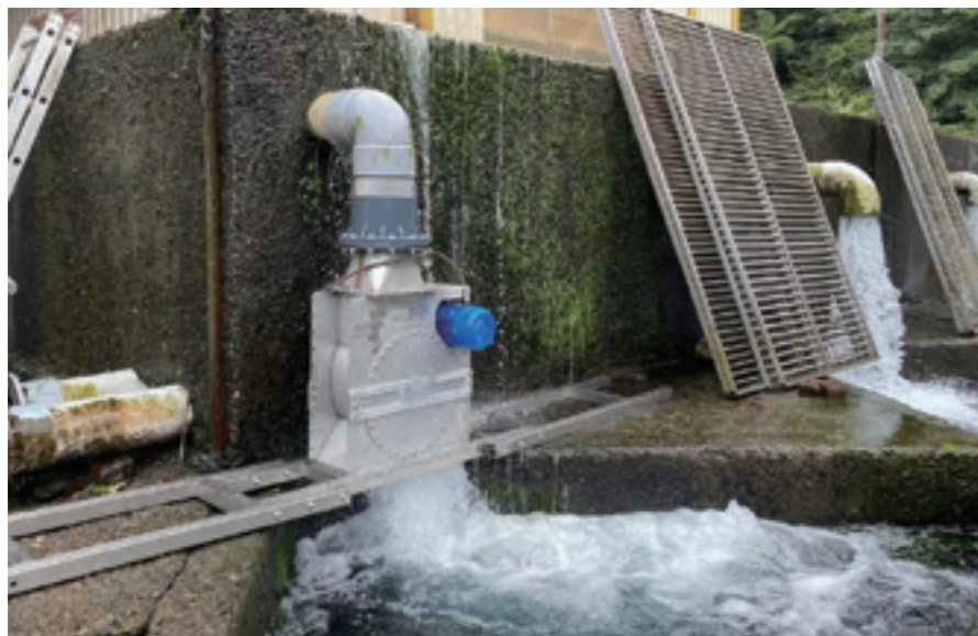
廣太綠能在鱒魚養殖場測試微水力發電機組效能
